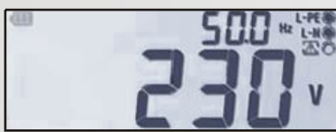
Pomiar napięcia i Hz
