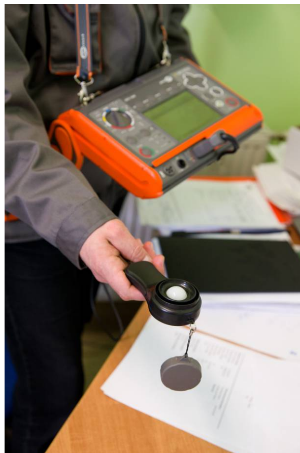
fot. Pomiar natężenia oświetlenia
